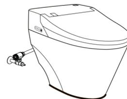
В промежуток между нижним концом унитаза и полом может попасть вода. Для предупреждения проникновения воды нанесите силикон.
